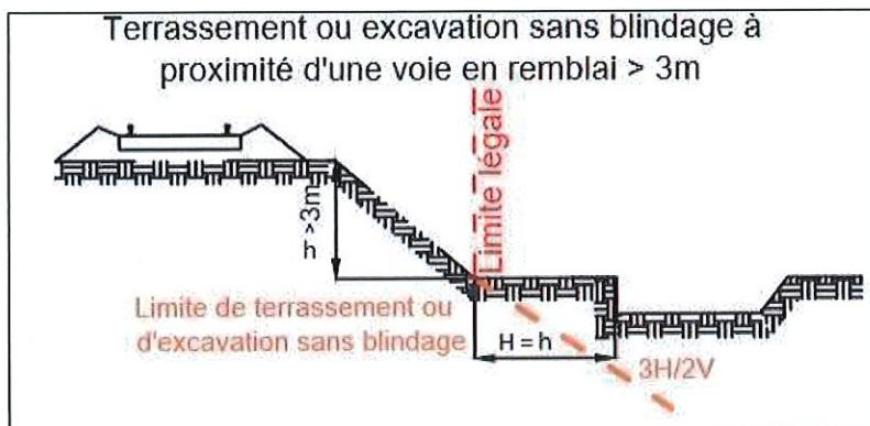
Nota : les remblais de plus de 3 mètres de hauteur (h) bénéficient d'une double protection :
