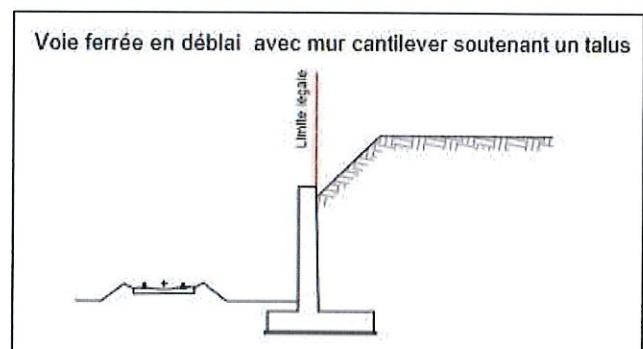
Voie ferrée en déblai avec mur dans talus
