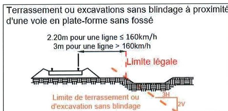
**Exemple 2 : matérialisation de la limite d'excavation, de terrassement et de fondation sans blindage à partir de l'emprise de la voie ferrée pour l'ouvrage d'art aérien.**
